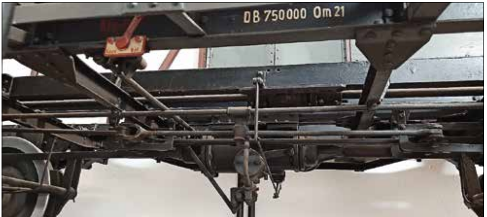
Bremsgestänge des Modell-Güterwagens Om 21
