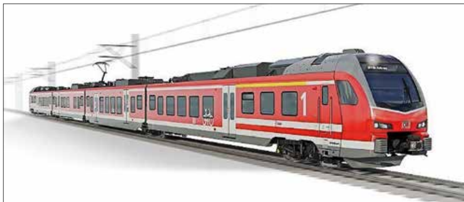
Neun solcher vierteiligen Elektrotriebwagen FLIRT XL (DB-Baureihe 429) mit ETCS-Ausrüstung sind 2022 bei Stadler, speziell für die Ausbaustrecke, bestellt worden Grafik: Stadler
