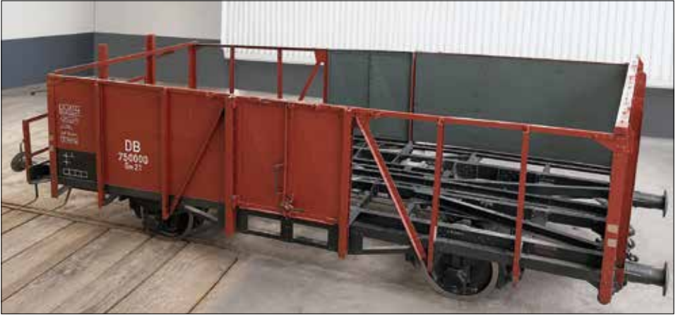
Modell- Güterwagen Om 21: Länge 1,95 m, Breite 0,60 m, Höhe 0,50 m
