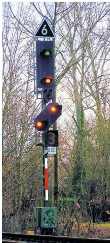
H/V-Lichtsignal als Einfahrtsignal des Bahnhof Friedrichsdorf an der Taunusbahn 2007: Der obere Schirm ist ein Hauptsignal (weiß-rot-weißes Mastschild) und zeigt „Fahrt mit Geschwindigkeitsbeschränkung“ (Hp2) an. Der obere Wimper (Zs3) definiert die Geschwindigkeitsbeschränkung ab dem Hauptsignal auf 60 km/h. Der untere schräge Schirm ist ein Vorsignal und zeigt „Halt erwarten“ (Vr0) an. Da die Fahrt auf einem Stumpfgleis endet, zeigt darunter der Geschwindigkeitsvoranzeiger (Zs3v) an, dass ein Geschwindigkeitsanzeiger (Zs3) mit 30 km/h zu erwarten ist. Quelle: wikimedia.org/MdE/Signalbuch 301 0301
