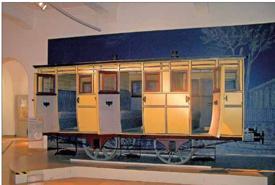
Ludwigsbahn-Personenwagen № 8, 1. Klasse, mit Ölbeleuchtung, ohne Bremse, Original im Zustand nach Umbau 1844 DB Museum Nürnberg, Fahrzeughalle 1
