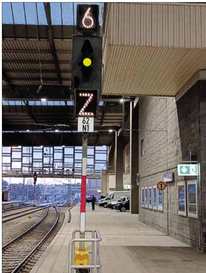
Ks-Signal nur mit Hauptsignalfunktion in Chemnitz Hbf (Mastschilder weiß-rot-weiß), Ks2 für Ausfahrt mit Zs3 60 km/h und Zs2 mit „Z“ in der Bedeutung Richtung Zwickau
