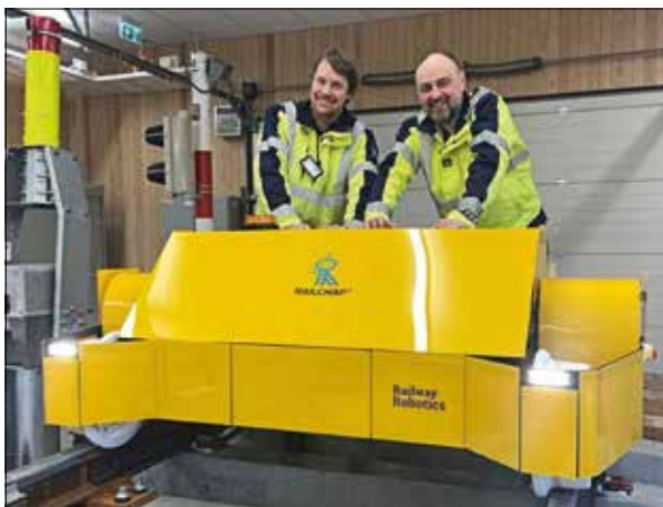
Prototyp des automatischen Weichen-Inspektionsgerätes RAILCHAP Quelle: Pressebild Railway Robotics/Norwegen
