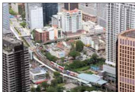
Zweigleisige Einschienenbahn im Zentrum von Kuala Lumpur mit zwei SUTRA-Zügen von Scomi Rail Fotos: K-P Schmidt (2x)
