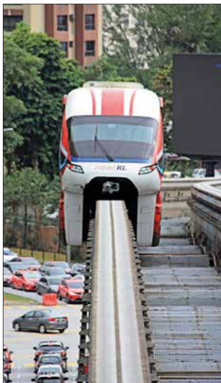
Frontansicht des Einschienenfahrzeugs SUTRA von Scomi Rail Quelle: www.nahverkehrspraxis.de/mobilitaet-in-kuala-lumpur/
