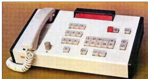
DR-Sprechanlage FADA für Kreisdispatcher und Fahrdienstleiter aus den 1980er Jahren, Hersteller VEB Funkwerk Kolléda Sammlung Tannigel
