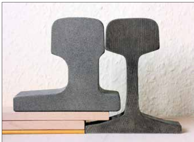
Ein unbearbeitetes Zungen-Vollprofil (links) neben einer Backenschiene. Der Gleitstuhl für die Weichenzunge wird hier durch Holzleisten angedeutet. Sammlung Schmidt
