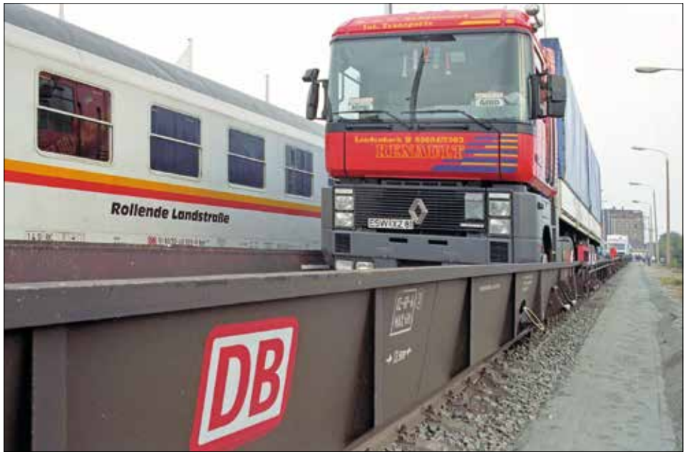
Die Elbtal-RoLa mit DB-Niederflurwagen zum Transport von Kombi-Lkw in Dresden-Friedrichstadt – Der weiße Personenwagen „Rollende Landstraße“ läuft dann im Zug gleich hinter der Lok mit. Quelle: MDR, Bildrechte: picture-alliance/ ZB | Matthias Hiekel
