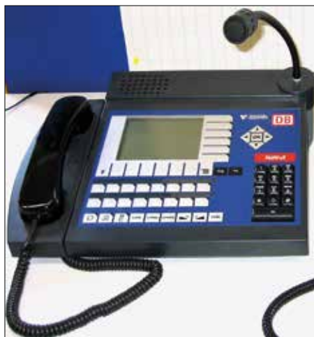
Ortsfester GSM-R-Fernsprecher (GeFo) Typ WENZEL, Hersteller Wenzel Elektronik GmbH Pinneberg
