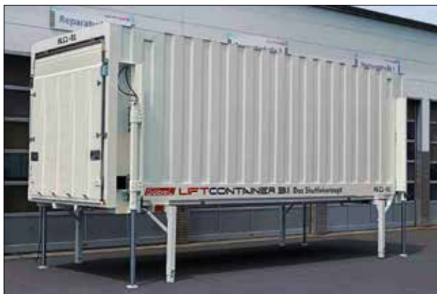
Die Wechselbrücke ist ein beladbarer Container mit einklappbaren Standbeinen, die beim Absender ohne Kran von einer Zugmaschine unterfahren und zum Terminal gebracht wird. Dort braucht man dann doch einen Kran, um sie auf den Bahn-Flachwagen zu platzieren. Foto: Göbel Fahrzeugbau
