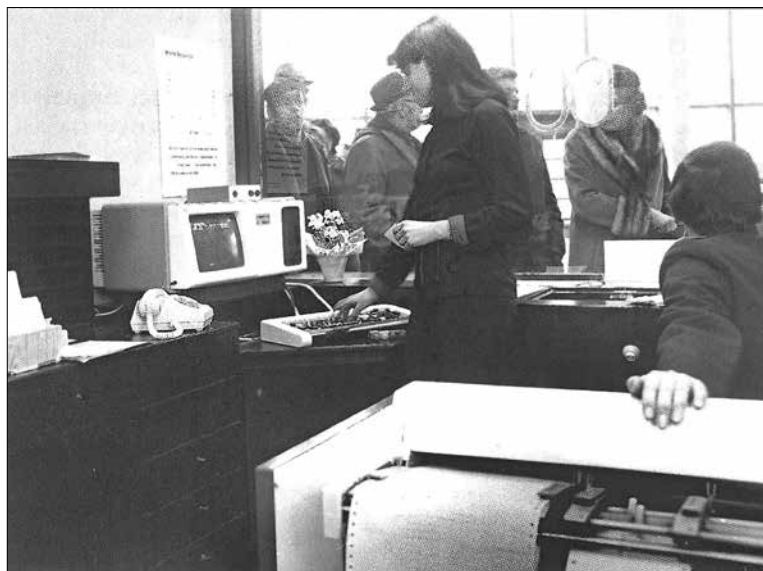
EPLA-Terminal PRT 20.1 der DR 1989 in Berlin- Lichtenberg ausschließlich zum Platzkar- ten-Ausdruck Foto: ZBDR/ Zimmer
