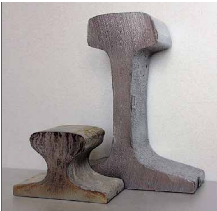
Profil LDE1 (63,5 mm) und R 65 (180 mm) mit abgenutzter rechter Fahrkante
