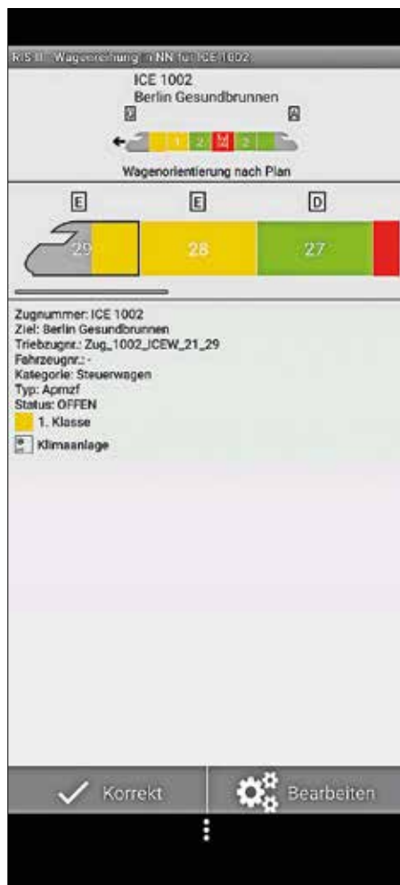
Das Handy des Zugchefs ist bereit zum „Bearbeiten“ der Wagenreihung. Mit „Korrekt“ geht diese elektronisch an den Zugzielanzeiger am Bahnsteig und an die DB Navigator App.
