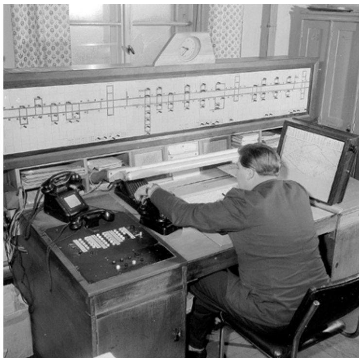
Der Kreisdispatcher der Strecke Bitterfeld–Jüterbog im Rba Lutherstadt Wittenberg verfügte 1962 bereits über ein Streckenleuchtbild, das anzeigte, wo sich die Züge befanden.
