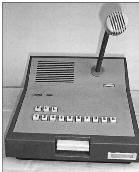
FKWA-Nebenstelle beim Fahrdienstleiter bzw. Bahnhofsdurchschalter um 1975 Foto: Buchweitz
