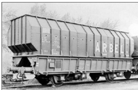
Offener Selbstentladewagen der Gattung Fd (bis 1967: Gattung SVw) der SNCF, ein Zwei-achser des Typs ARBEL 1955 (Lastgrenze bei Streckenklasse C: 28,1 t). ARBEL = franz. Waggonbau- und Montantransport-Konzern Foto (3x):N.N.; Überlieferung: Bildarchiv REE modèles, www.ree-modeles.com
