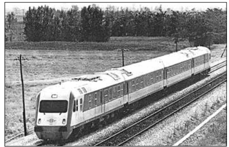
Dieselelektrischer Intercity-Triebzug DE-IC 2000N-05E für Griechenland im Juni 1989 auf Testfahrt zwischen Neustadt (Dosse) und Paulinenaue. Dieser Zug war das Ergebnis eines Ost-West-Herstellerkonsortiums von LEW Henningsdorf, Waggonbau Bautzen und AEG West-Berlin. Sammlung Fölsch
