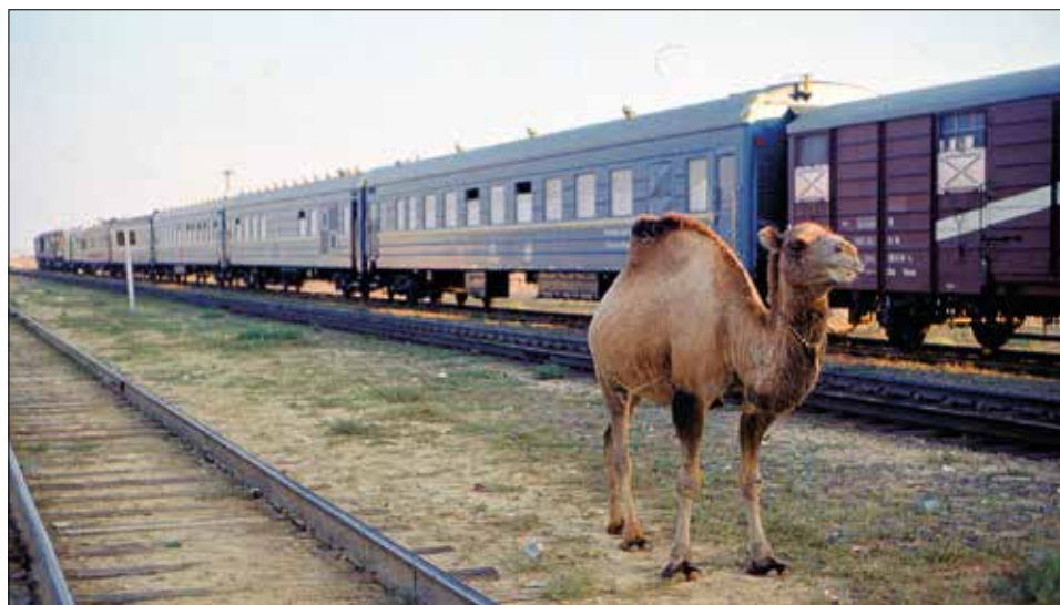
„Sommerzug“ der DR mit zweiachsigen Güterwagen auf Erprobung unter extremen klimatischen Bedingungen in der Wüste Karakum/Usbekistan (im Jahr 1974) Foto: W. Rettig
