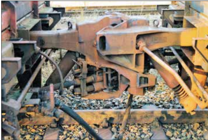
AMK INTERMAT nach mehrmonatlichem Betriebsinsatz; die Hauptluftleitung zu- sätzlich verbunden. Foto: W. Rettig
