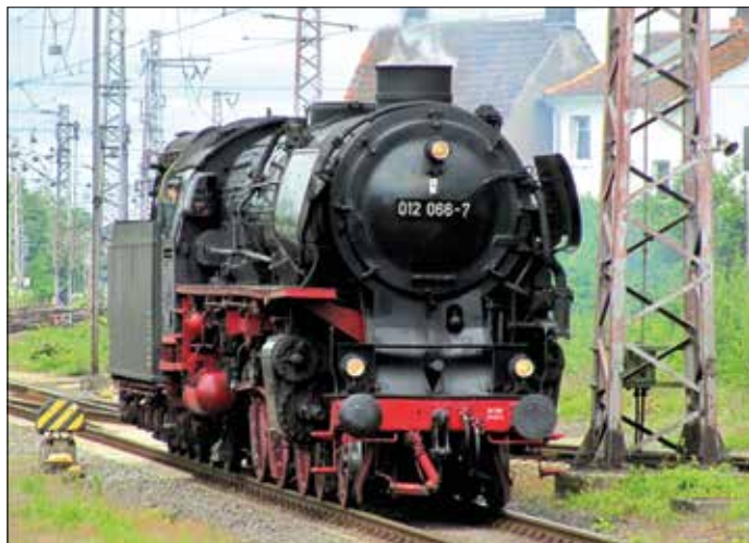
DB-Schnellzuglok der BR 01.10, BMAG (vormals L. Schwartzkopff) 1940/11322, 1957 Umbau auf Ölfeuerung
