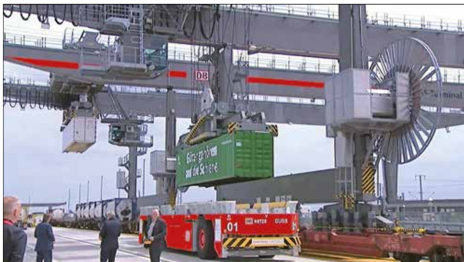
Zwei 80 Meter breite Portalkräne kurz hintereinander mit einem roten Transportfahrzeug auf der Betonfahrbahn. Foto: NDR
