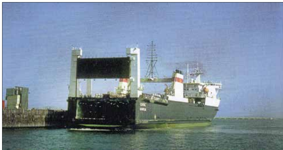
Die sowjetische Eisenbahngüterfähre "KAUNAS" fährt im April 1991 ins Hafenbecken von Mukran ein. Sie muss rückwärts anlegen, da sie nur hinten eine Heckklappe hat, die schon hochgezogen ist. Sammlung Noack/Foto: Friedhelm Ernst
