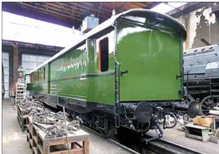
Aufarbeitung in Strasshof an der Nordbahn 2013 – Die alte Eleganz wird wieder sichtbar. Die Stirnseite kann als Auffahr-rampe heruntergeklappt werden. Foto: A. Zwingenberger
