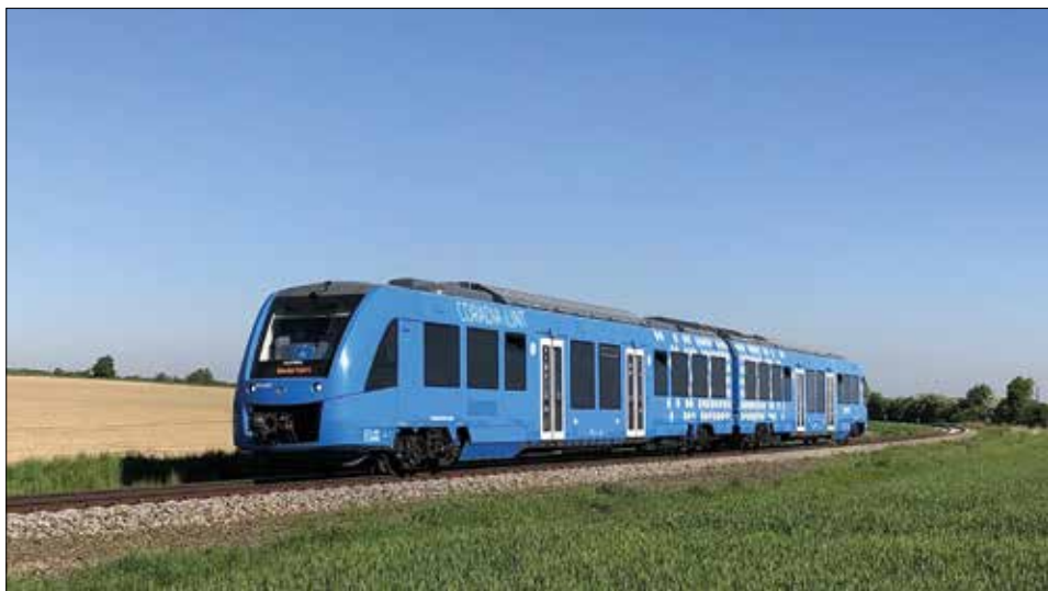
Der Brennstoffzellen-Triebzug Coradia iLint Anfang 2020 auf einer Testfahrt in der niederländischen Provinz Groningen. Das niederländische Eisenbahnnetz umfasst knapp 700 Kilometer nicht-elektrifizierter Strecken, auf denen täglich etwa 100 Dieselzüge unterwegs sind. Werkfoto Alstom
