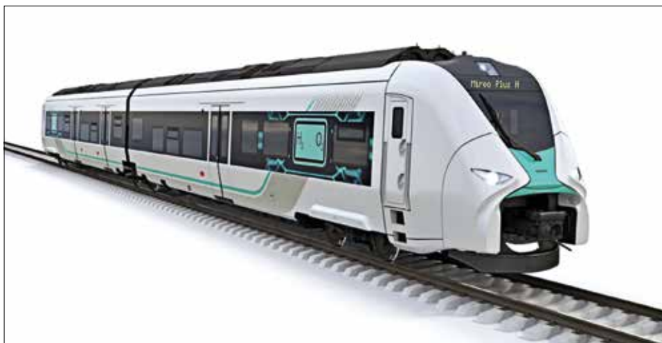
Der zweiteilige Triebzug Mirio Plus H von Siemens Mobility tankt komprimierten Wasserstoff. Daraus erzeugt eine Brennstoffzelle die elektrische Energie für die Fahrmotoren. Werkfoto Siemens Mobility
