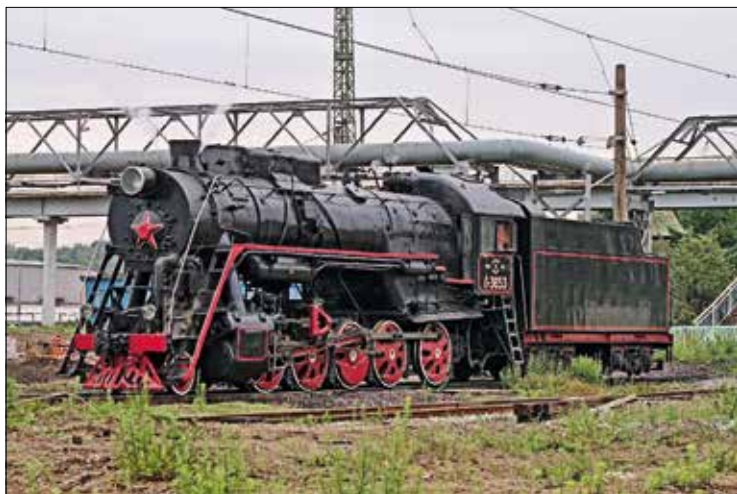
Güterzugdampflokomotive der SZD-Baureihe L – „L“ steht für den Chefkonstrukteur Lew Lebedjanski. Lugansk baute ab 1945 2 048 Maschinen davon, zwei andere russische Lokfabriken 2 151 Stück. Heute steht die L-3653 noch betriebsfähig im Depot Podmoskowskaj. Foto: Neu-Zwei auf https://img-fotki.yandex.ru
