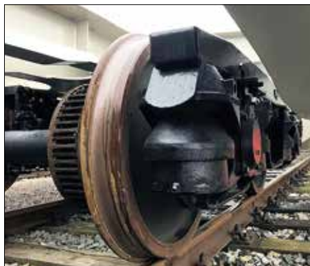
Neuentwickeltes Drehgestell mit dämpfender, verschleißärmerer Gummifederung
