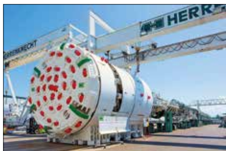
Tunnelbohrmaschine für den Erkundungsstollen Mauls-Brenner (Vortrieb seit Mai 2018)
