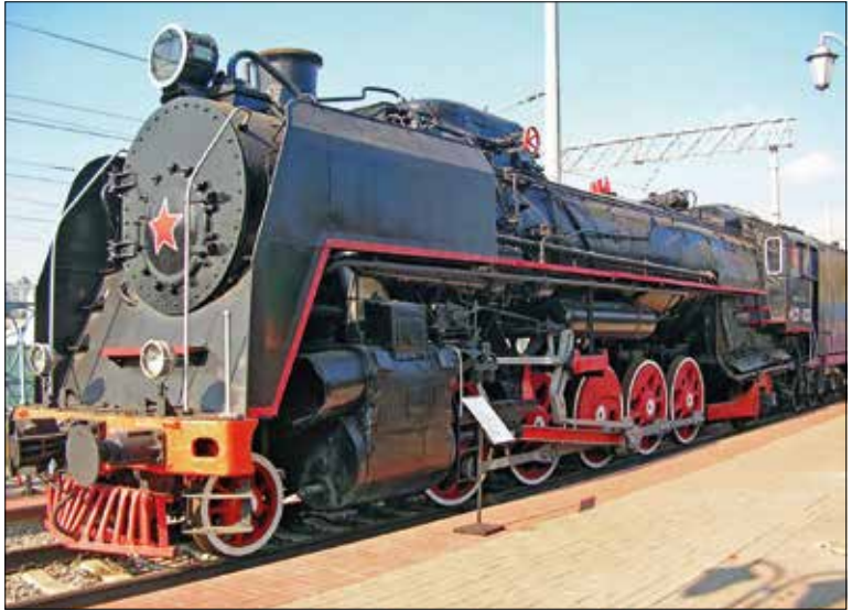
Dampflokomotive FD 21-3125 (1'E1'h2) im Eisenbahnmu- seum Rigaer Bahn- hof in Moskau Foto: Engineer gena
