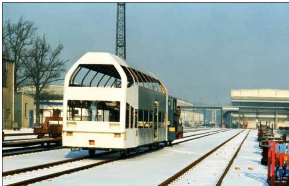
Der Rohbau eines Doppelstock-Triebwagens wird im Werksgelände der DWA-Dessau zur weiteren Fertigung rangiert. Foto: René Guthier (3.2.1996)/Sammlung Bernd Neddermeyer
