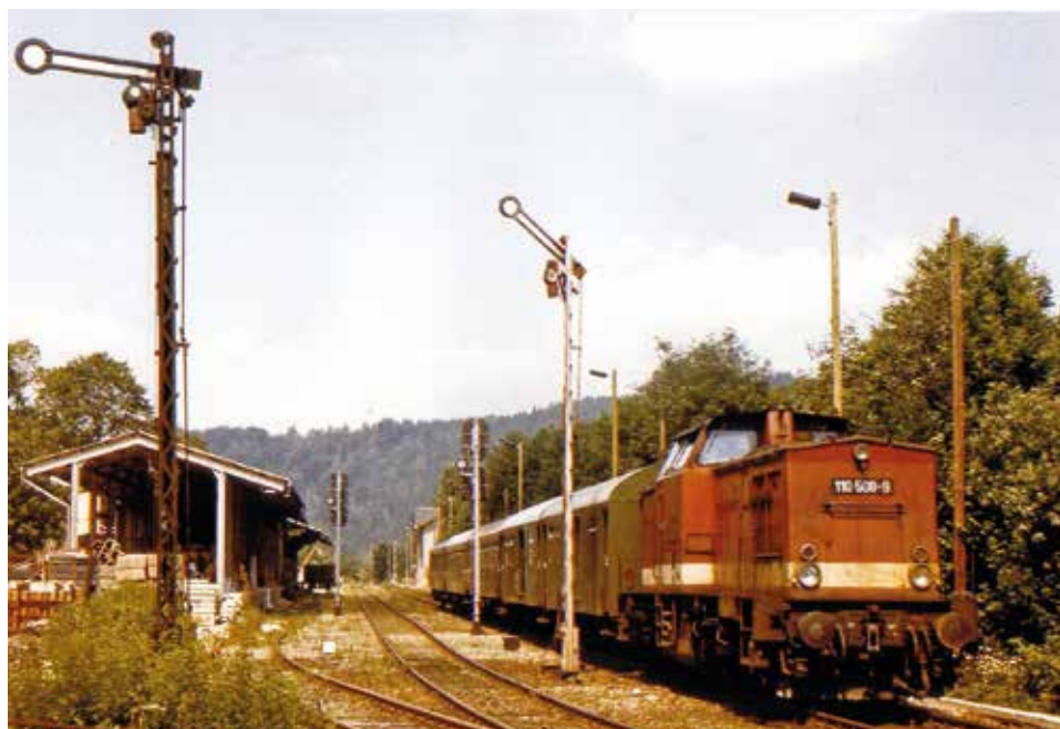
Eine typische Personenzuggarnitur der 1980er Jahre fährt gerade im Bahnhof Waldkirchen ab. Auffällig ist die Signaltechnik: Während der Zug noch herkömlich „Fahrt Frei“ vom Formsignal erhält, stehen schon die modernen Lichtsignale des sowjetischen Systems EZMG bereit, den Dienst aufzunehmen (1987-2005). Typisch für die EZMG-Signale sind die ovalen Signalschirme mit den langgezogenen Schuten gegen die Sonneneinstrahlung.
