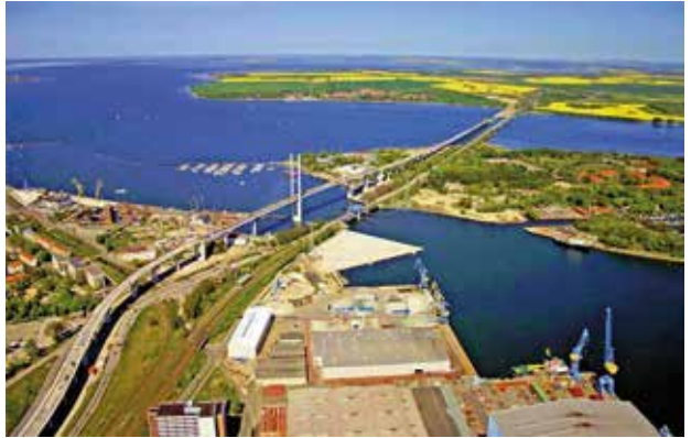
Brücken über den Strelasund, unten links Stralsund, mittig Insel Dänholm, oben rechts Insel Rügen Altefähr – rechte flache Brücke = Rügendamm von 1936, linke hohe Brücke = Rügenbrücke von 2007
