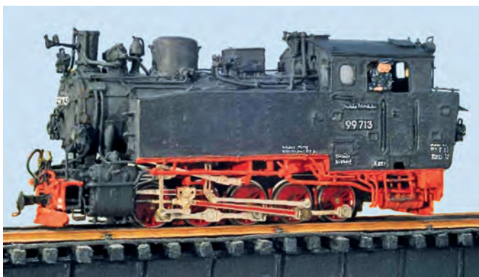
Schmalspurlok 99 713, Original 1927, Modell Rolf Schnabel 1991 – Karton-Aufbauten auf einem Bemo-Fahrwerk, Dampfdom und Läutewerk aus Lindenholz, Leitungen und Rohre aus Kupferdraht
