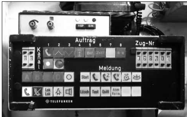
Hauptbediengerät / 4 BG-H 1206/4 der Fa. Telefunken für den analogen Zugbahnfunk auf DB-Loks
