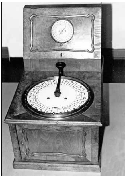
Zeigertelegraf auf Induktionsbasis nach Werner von Siemens, Berlin
