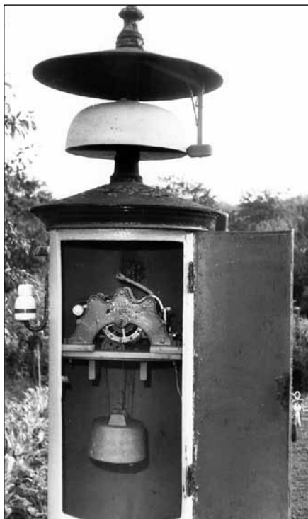
Blick in ein geöffnetes zylindrisches Siemens-Einheits-Läutewerk mit Triebwerk von W. Horn, Berlin, 1875
