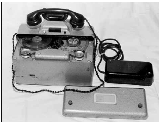
Sprachspeicher mit Magnetbandaufzeichnung im geöffneten Gehäuse, wie er bis in die 1960er Jahre bei der DR in Betrieb war.
