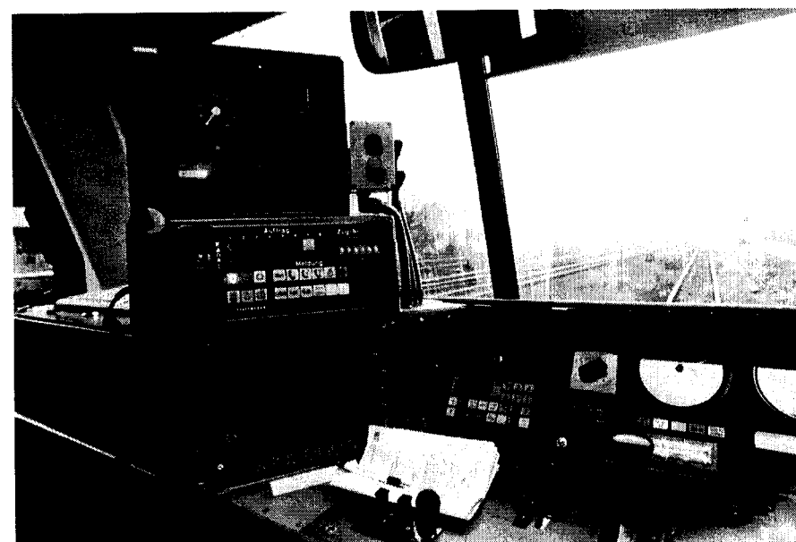
Fahrzeugeinrichtung für den FunkFahrbetrieb (FFB) im Führerstand eines Triebwagens der Baureihe 628.
